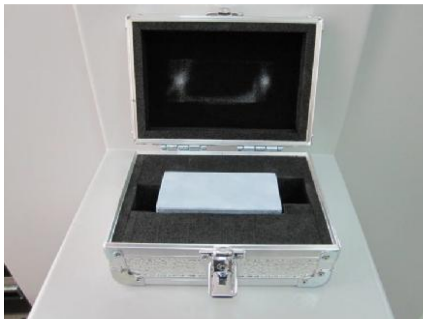
Рисунок 3- Общий вид эталонной меры отклонений от плоскостности 130
