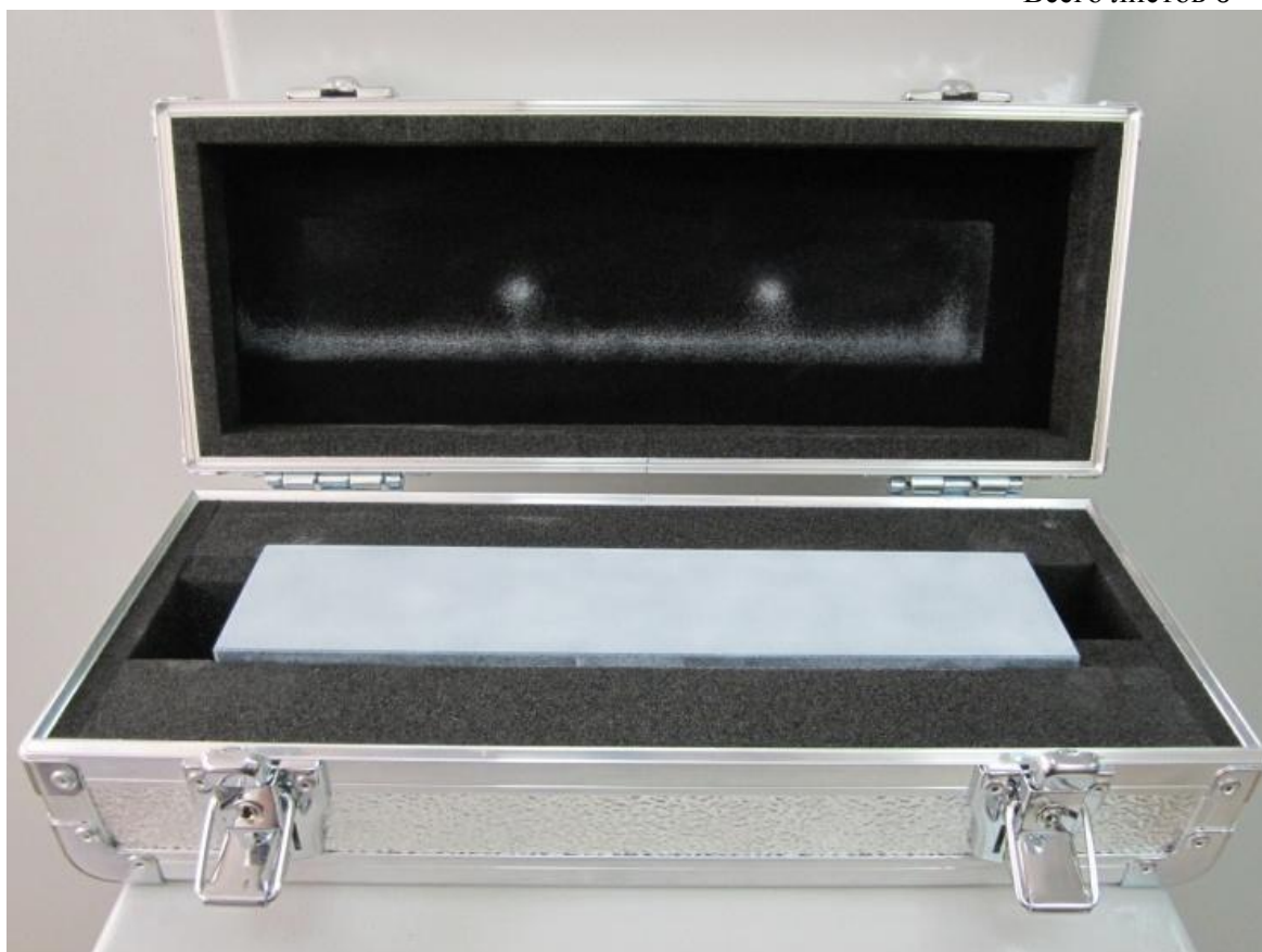
Рисунок 4- Общий вид эталонной меры отклонений от плоскостности 300
