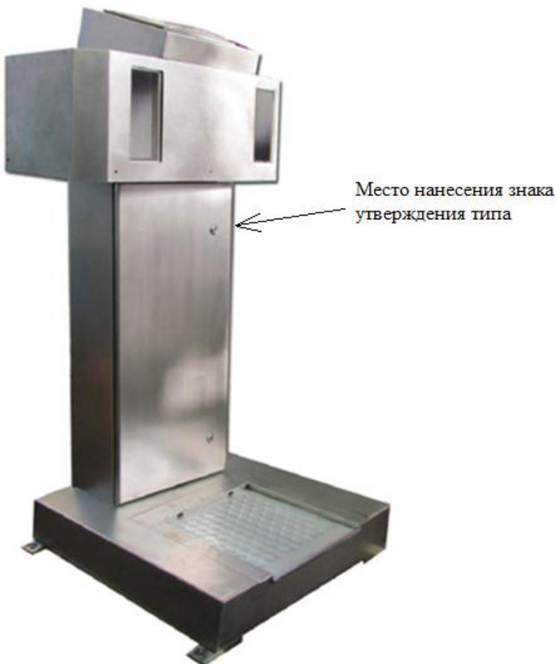
Рисунок 1 – Общий вид установки контроля радиоактивного загрязнения персонала «РЗБ-04м»
