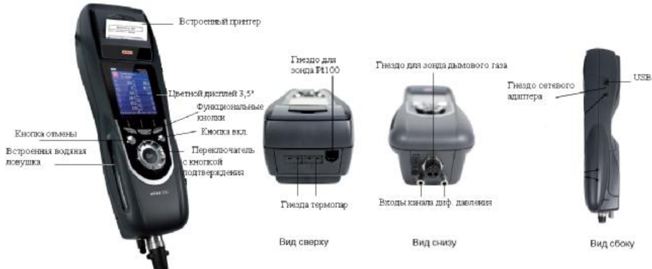
Рисунок 7. Компоненты блока анализатора дымовых газов KIGAZ 200
