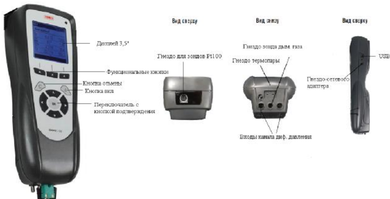
Рисунок 6. Компоненты блока анализатора дымовых газов KIGAZ 150
