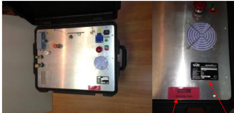
Место пломбировки винта крепления панели Наклейка
