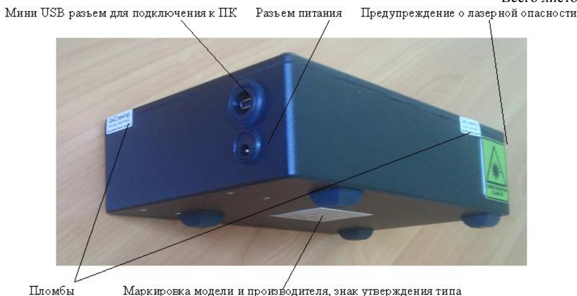
Рисунок 2 - Схема пломбирования и маркировки спектрометра люминесцентного портативного «ИнСпектр» L405
