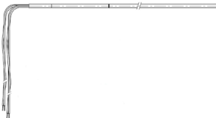
Рис. 1. Внешний вид преобразователя термоэлектрического с двумя термопарами модели 1133-11-715/3*3000.
