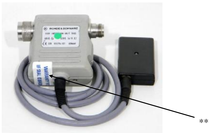
Рисунок 3 – Внешний вид преобразователей первичных URV5-Z2, URV5-Z4
