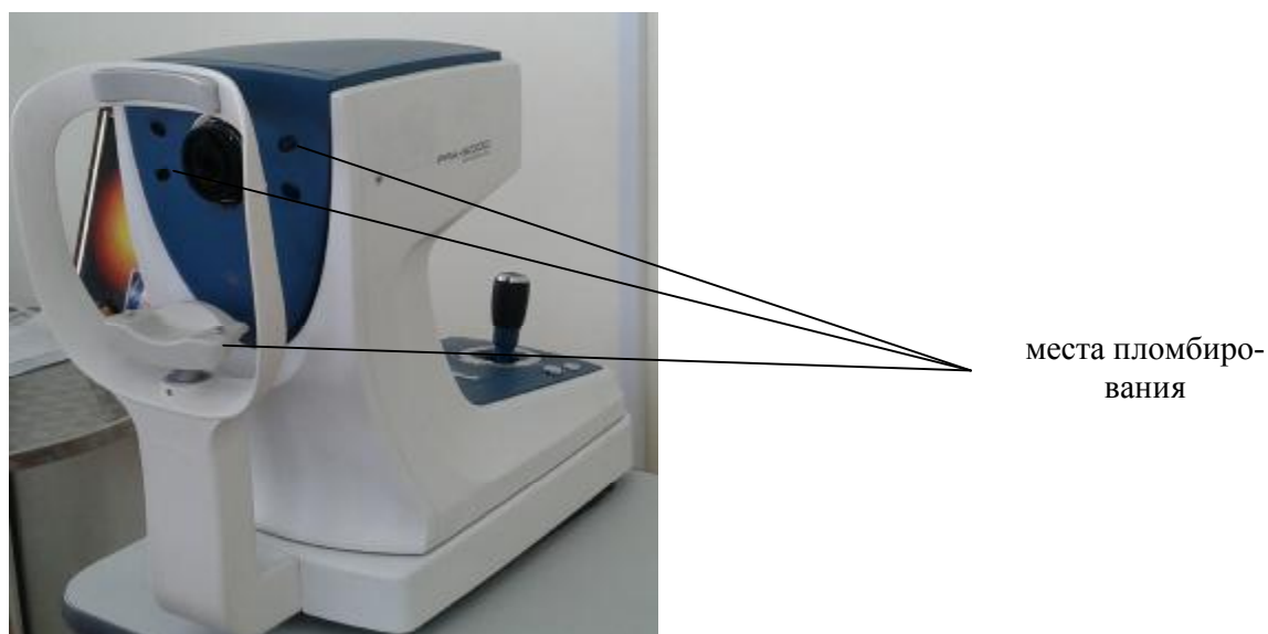
Рисунок 3 – Общий вид авторефрактометра PRK-6000 и схема его маркировки
