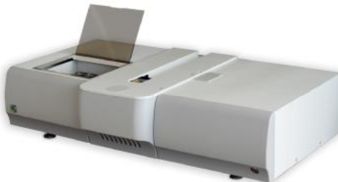
Рисунок 1 – Общий вид Спектрометра атомно-абсорбционного «КВАНТ.Z1»
