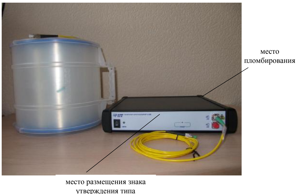
Рисунок 1 – Внешний вид рабочего эталона единиц длины и ослабления в световоде с указанием мест пломбирования и размещения знака утверждения типа
