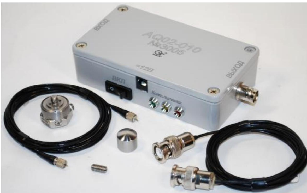
Рисунок 1 – Внешний вид канала измерительного динамических нагрузок AP1015
