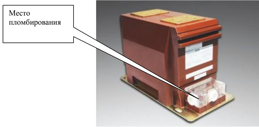
Первичные и вторичные обмотки залиты компаундом, который обеспечивает основную изоляцию и формирует корпус трансформатора. Выводы первичной обмотки выведены на верхнюю часть литого корпуса в виде контактных площадок с отверстиями для болтов М12. Вторичные обмотки выведены в литую коробку для зажимов, закрытую пластмассовой крышкой и расположенную у основания трансформатора на узкой боковой стенке. Крышка, закрывающая зажимы, пломбируется для исключения несанкционированного доступа.
