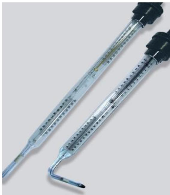
Принцип действия термометра основан на тепловом изменении объема термометрической жидкости (ртути), в зависимости от температуры измеряемой среды и на способности ртути проводить электрический ток.
