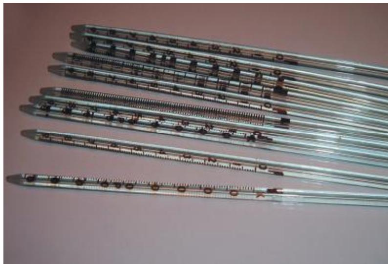
Капилляры представляют собой прямую стеклянную трубку, верхний и нижний торцы которой зашлифованы. Нижний торец зашилифован под углом 20° на длине 6-7 мм. На капилляре нанесена шкала.
