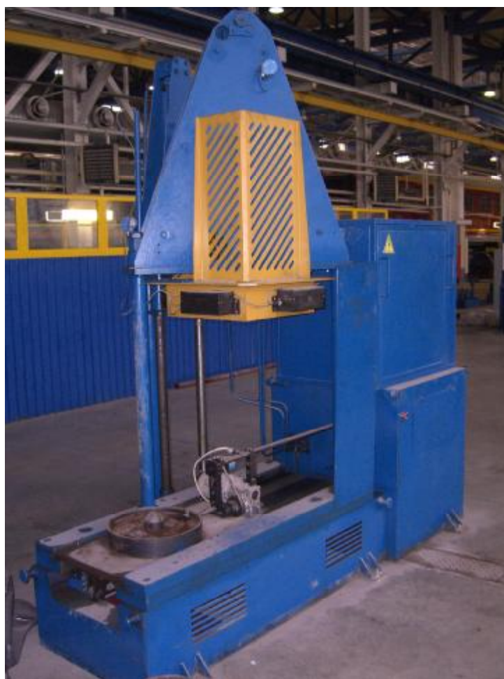
Рисунок 1 – Общий вид стендов автоматизированных для измерения и испытания параметров пружин пассажирских вагонов «Стрела-М1»
