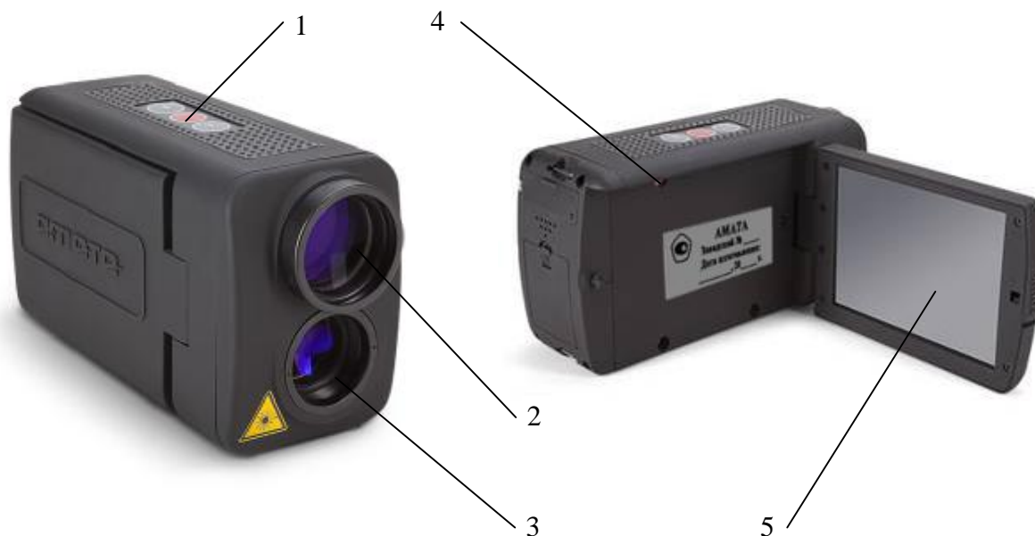
1-кнопки управления; 2-объектив приемного канала; 3-объектив канала излучения; 4- место пломбирования; 5-дисплей
