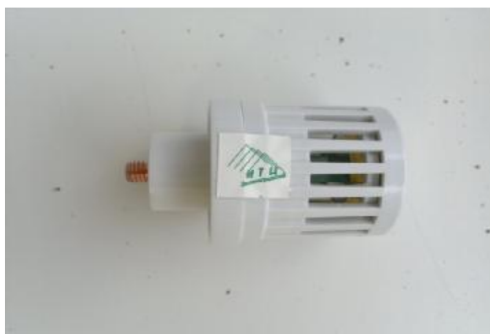
Рисунок 2 – Место нанесения специальной пленочной пломбы
