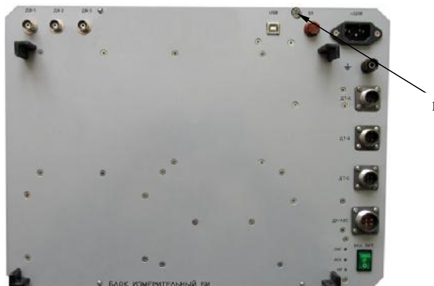
Рисунок 2 - Схема пломбировки ПКСОД-М
