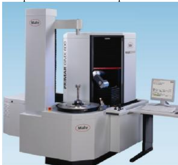
Рисунок 1 – Общий вид приборов зубоизмерительных PRIMAR GMX 600
