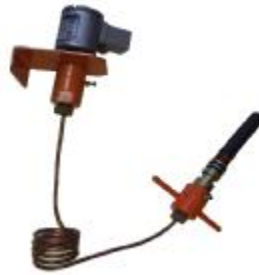
Измеритель давления бурового раствора ИДБР-2
