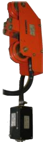
Измеритель натяжения каната ключа ИНКК-2
