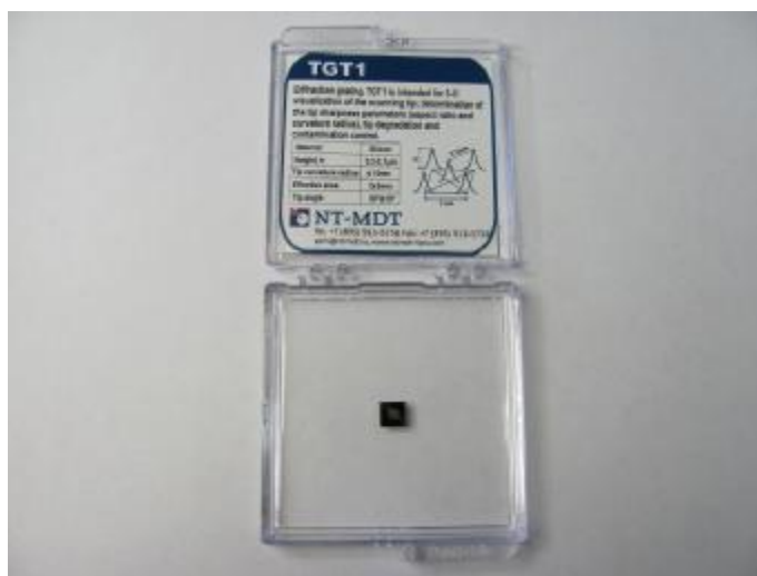
Рисунок 1 - Внешний вид меры периода линейно-угловой TGT1.
