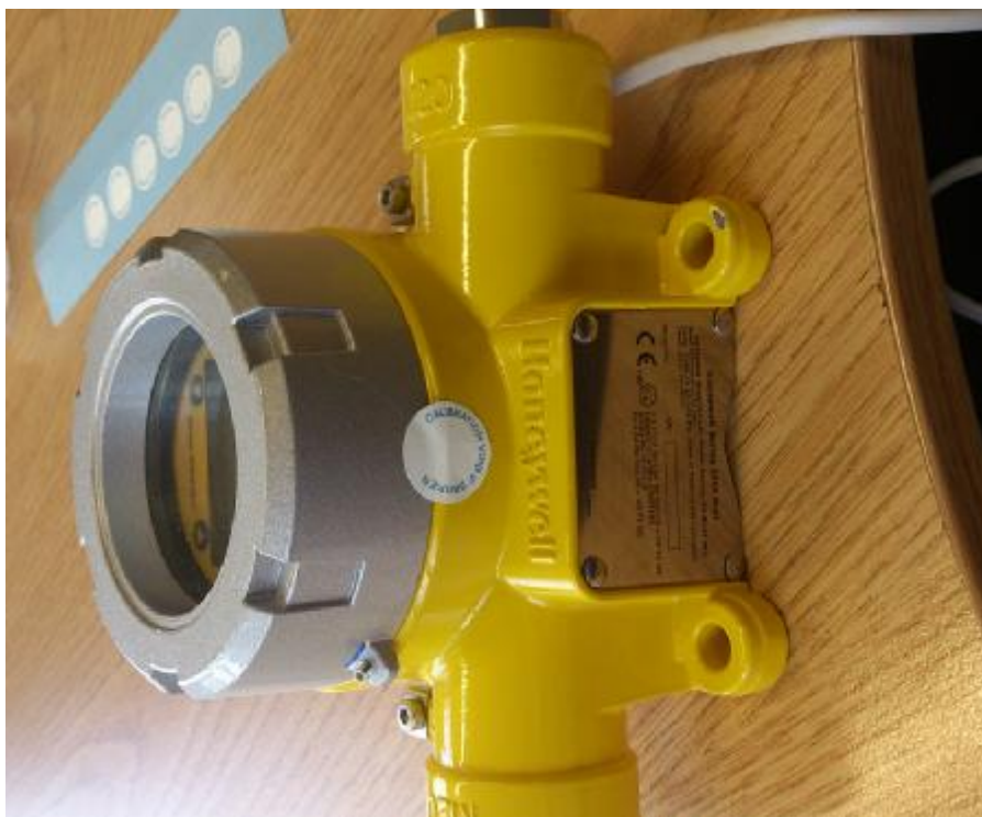
Рисунок 2 – Защита корпуса от несанкционированного доступа
