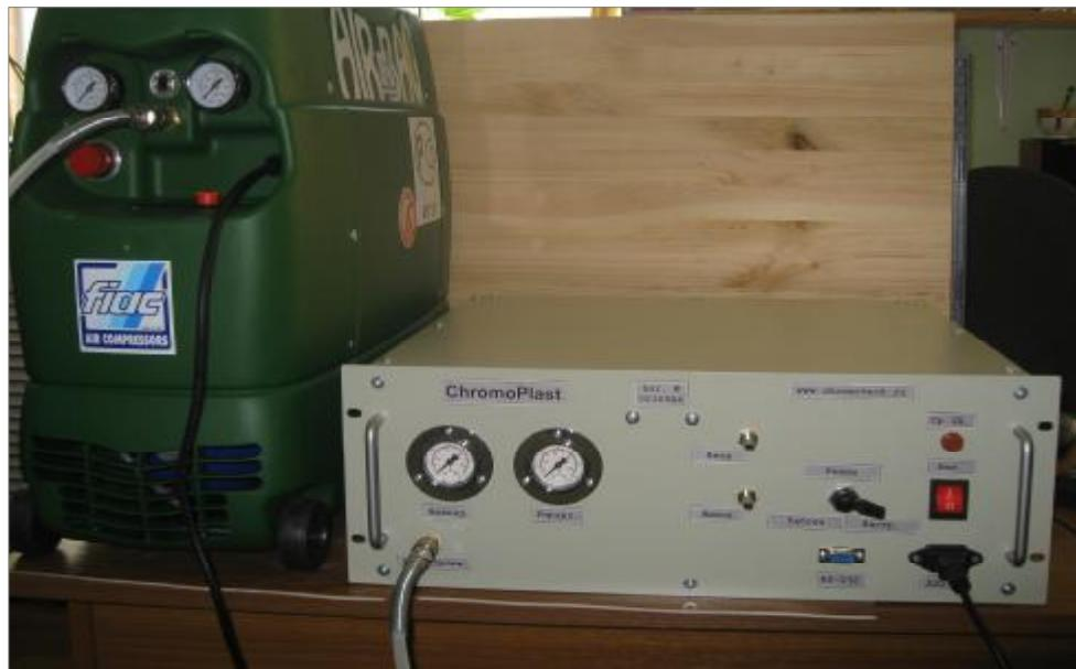
Рисунок 1 - Газоанализатор хроматографический Хромопласт
