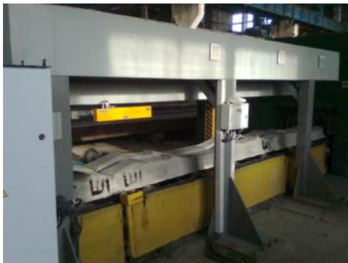
Рисунок 1. Общий вид системы автоматизированного контроля геометрических параметров железобетонных шпал
