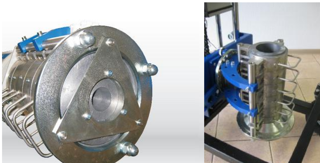
Рис. 3 Внешний вид съемных коллиматоров толщиной 100 мм (защита СЕГР-M100) и 50 мм(защита СЕГР-M50)
