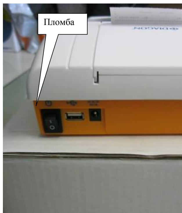
Рисунок 2 – Коагулометры полуавтоматические модели Coag 4D D-Dimer. Расположение пломбы.
