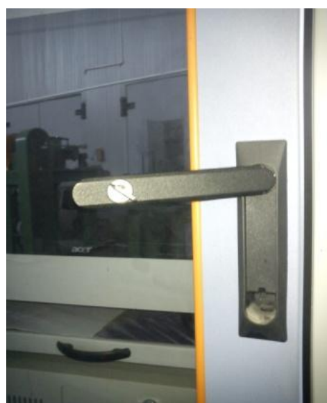
Рисунок 3 – Внешний вид замка на дверце стойки управления
