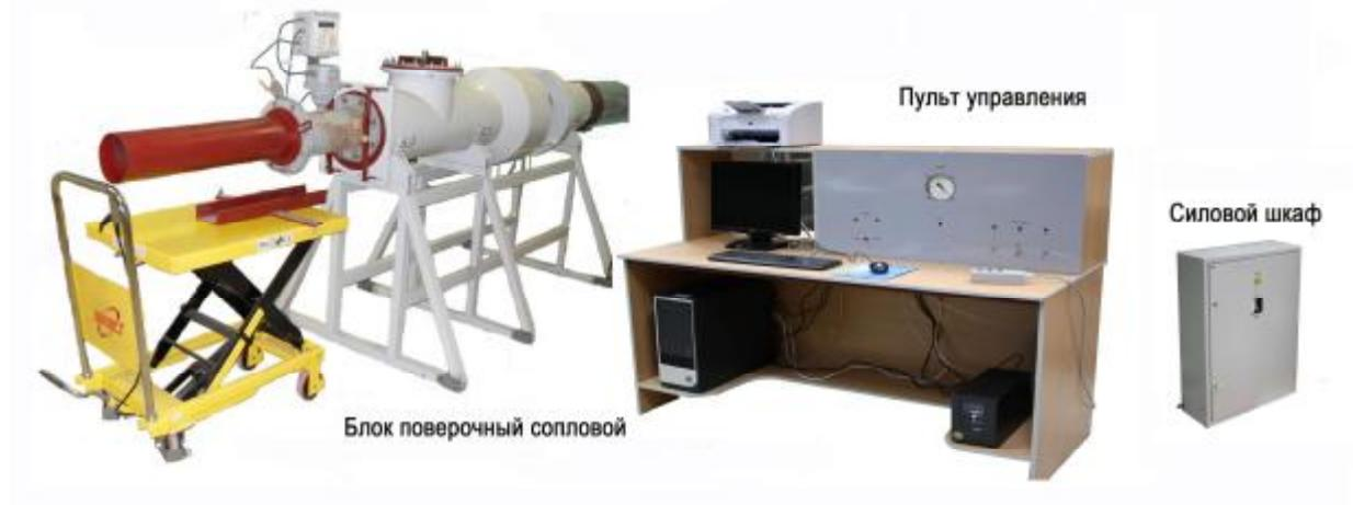
Установка работает следующим образом. Воздух из помещения, где размещена установка, проходит последовательно через входной прямолинейный участок, поверяемый счётчик, выходной прямолинейный участок, набор критических сопел, ресивер, блок компрессоров, блок шумогашения и выходит в помещение или на улицу.
