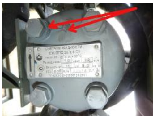
Р и с у н о к 2 – Схема пломбировки счетчика жидкости колонок топливораздаточных переносных с ручным приводом КР-40-1-0,25М.
