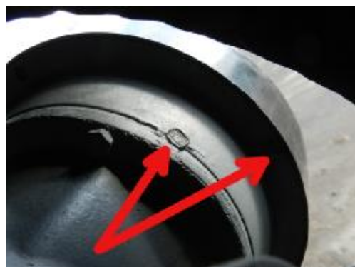
Р и с у н о к 2 – Схема пломбировки счетчика жидкости колонок топливораздаточных переносных с ручным приводом КР-40-1-0,25М.
