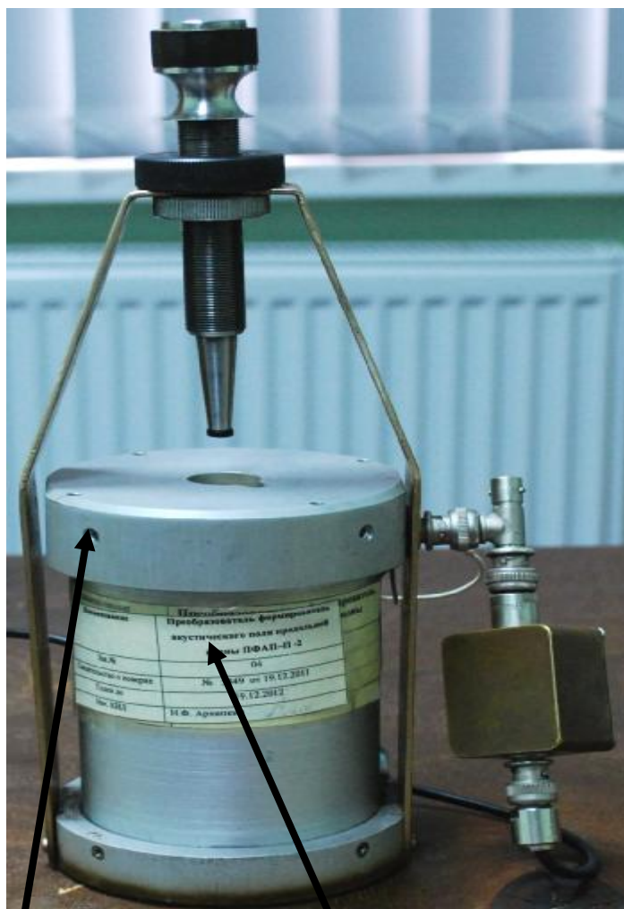
Рисунок 3 - Общий вид калибратора-преобразователя акустического поля продольной волны (УКП-АПП)
