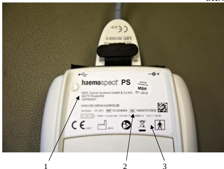
Рисунок 2 – Схема маркировки гемоглобинометра, 1- изготовитель, 2- серийный номер, 3-место нанесения знака об утверждении типа
