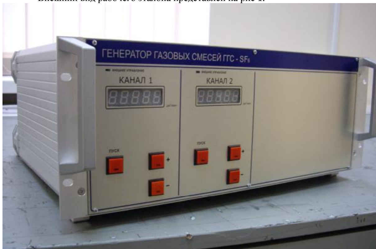
Рис. 1 Внешний вид генератора газовых смесей ГГС – SF 6 .
