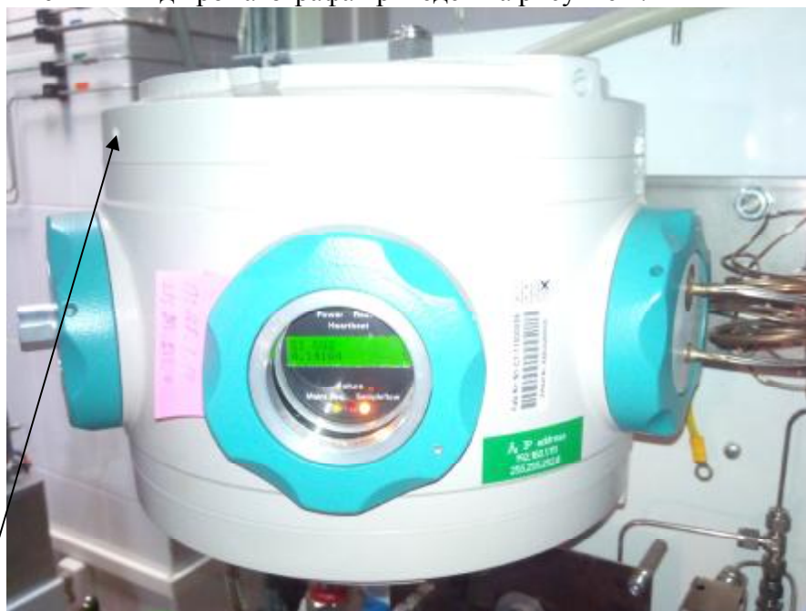
Рисунок 1. Внешний вид хроматографа газового промышленного специализированного MicroSAM
