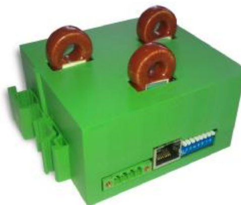
Рисунок 2 - Внешний вид блока прямых измерений БПИ РБША.426462.308-02-501/X/X/X/X с контактным способом подключения входов напряжения и бесконтактным способом подключения входов тока
