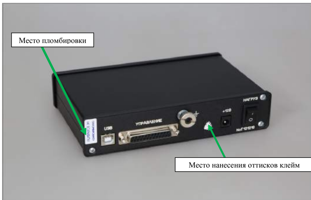
Рисунок 2 - Схема пломбировки от несанкционированного доступа и нанесения оттисков клейм
