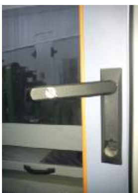
Рисунок 9 – Внешний вид замка на дверце стойки управления
