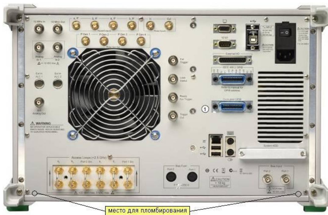
Рисунок 2 – Задняя панель анализатора и места для пломбирования.
