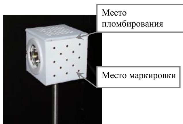
Рисунок 4 – Источник света прожекторного типа
