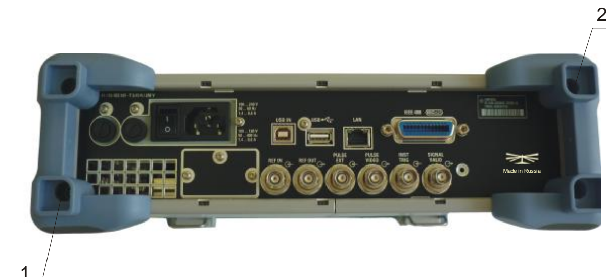
Рисунок 2 – Схема пломбирования от несанкционированного доступа
