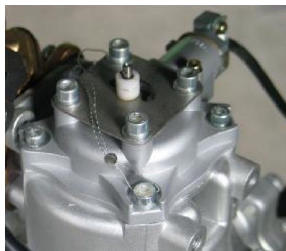
Рисунок 5 - Пломбировка датчика импульсов PS100
