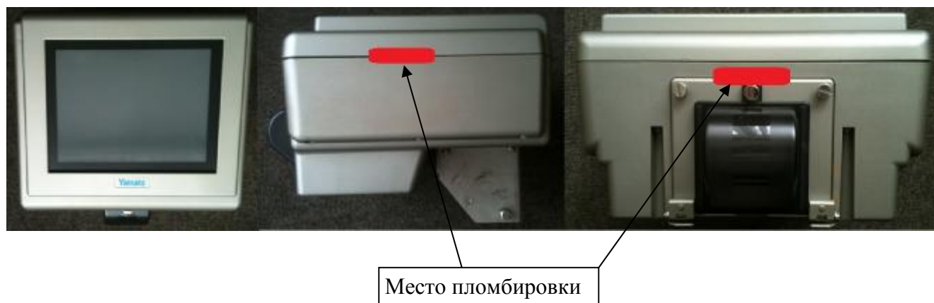
Рисунок 6 – Пломбировка корпуса индикатора RCU -810A
