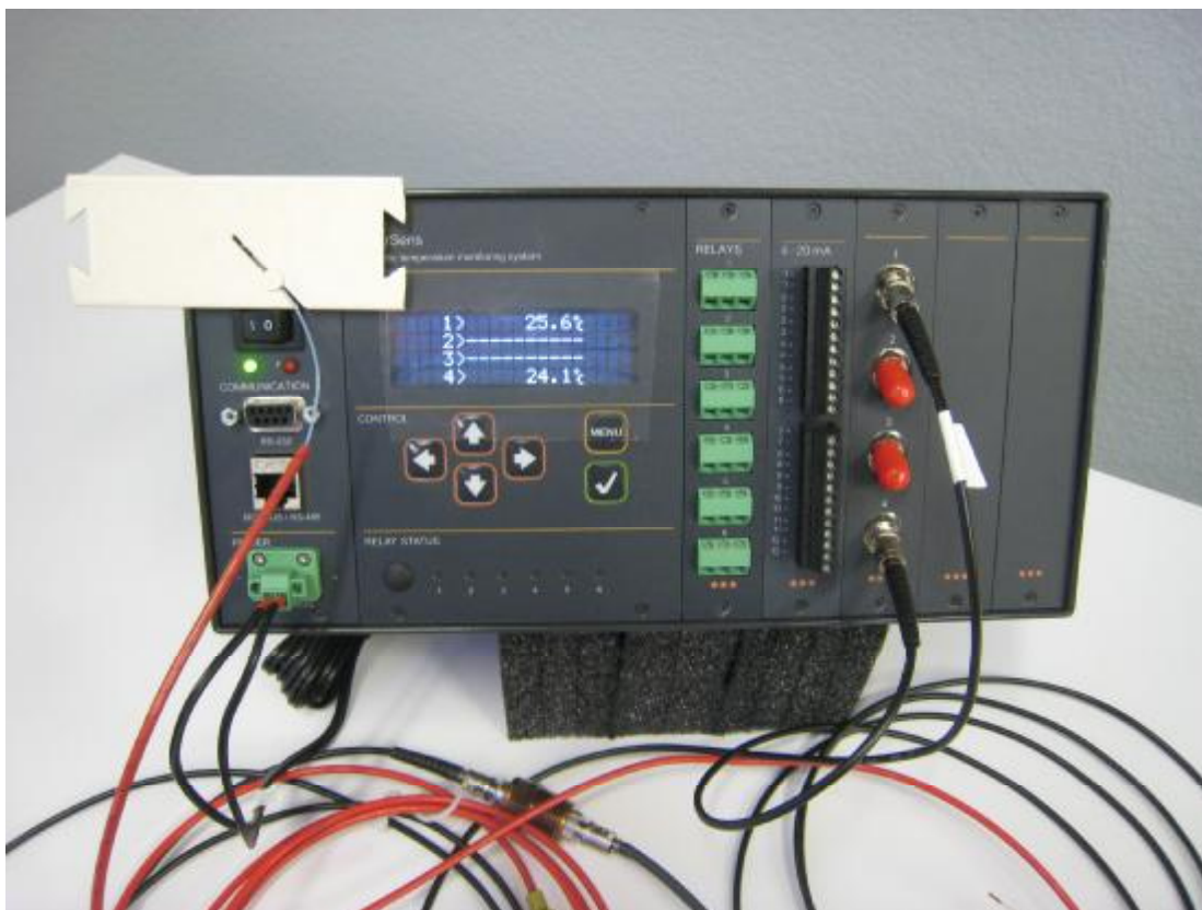
Рис. 1 - Система LumaSHIELD (4 канала) в сборе с 2-мя датчиками
