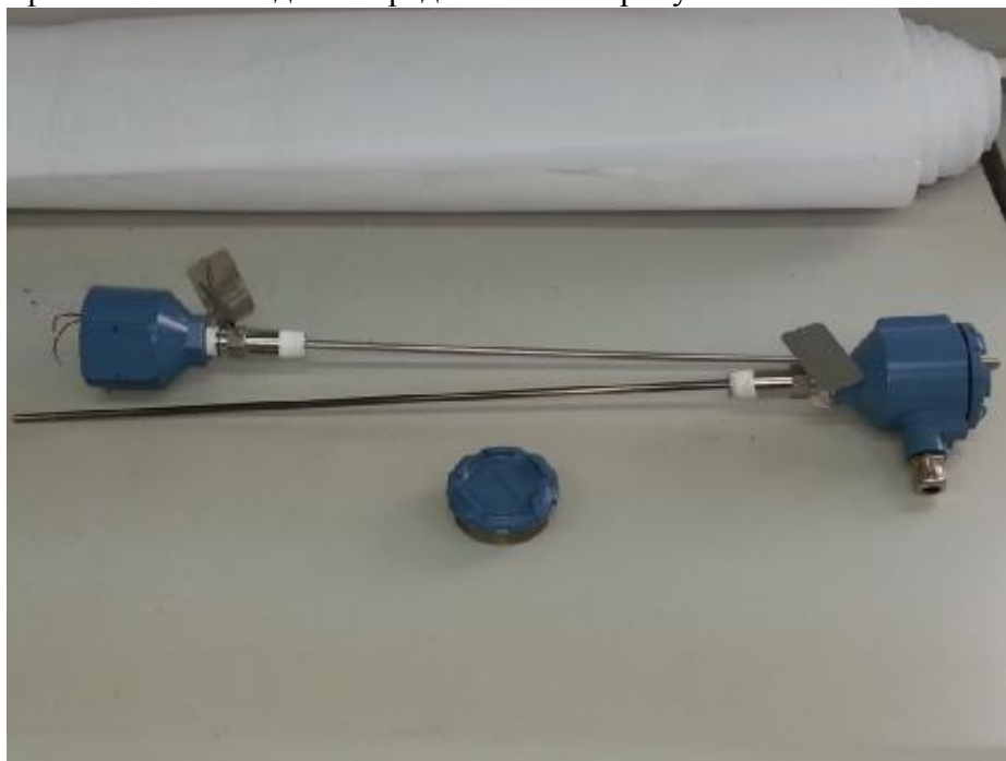
Рис. 1 – Термопреобразователь сопротивления платиновый Rosemount исполнения 0078D21A30B165T26
