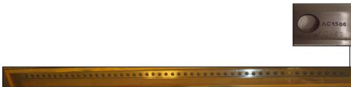
Рисунок 2 - Линейка специальная для измерения отклонения рельсов от прямолинейности ЛС-1500
