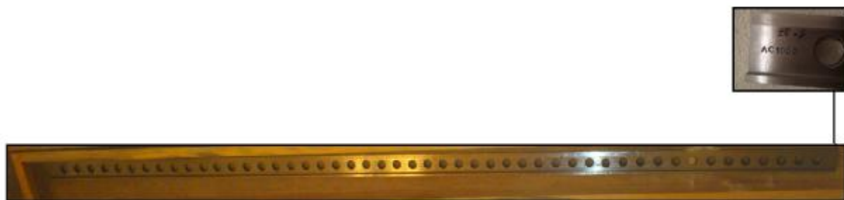
Рисунок 1 - Линейка специальная для измерения отклонения рельсов от прямолинейности ЛС-1000
