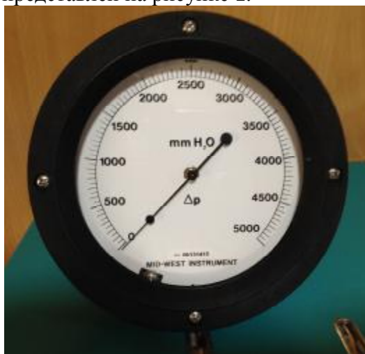
Рисунок 1. Фотография манометра дифференциального модель 106XE-10-(FUY)O.
