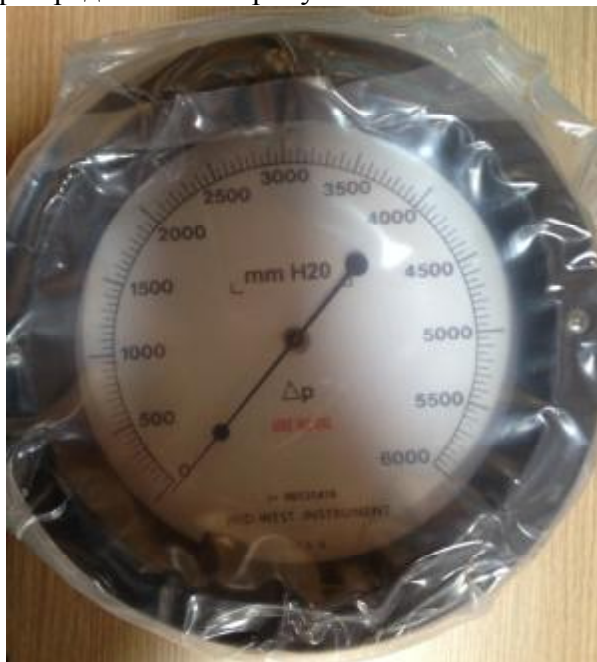
Рисунок 1. Фотография манометра дифференциального модель 106QE-10-(FTUY)O.
