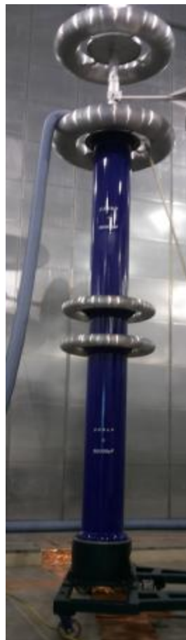
Рисунок 1. Внешний вид делителя напряжения высоковольтного TAWF 15000/450
