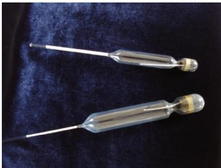
Ареометры для морской воды АМВ представляют собой полый стеклянный сосуд цилиндрической формы, запаянный с обоих концов. К верхней части корпуса припаян стеклянный стержень цилиндрической формы, запаянный сверху, внутри которого приклеена бумажная полоска с нанесенной ареометрической шкалой, градуированной в единицах относительной плотности для температуры 17,5 °C. Нижняя часть корпуса ареометра заполнена балластом (дробью), сообщающим ареометру вертикальное положение
