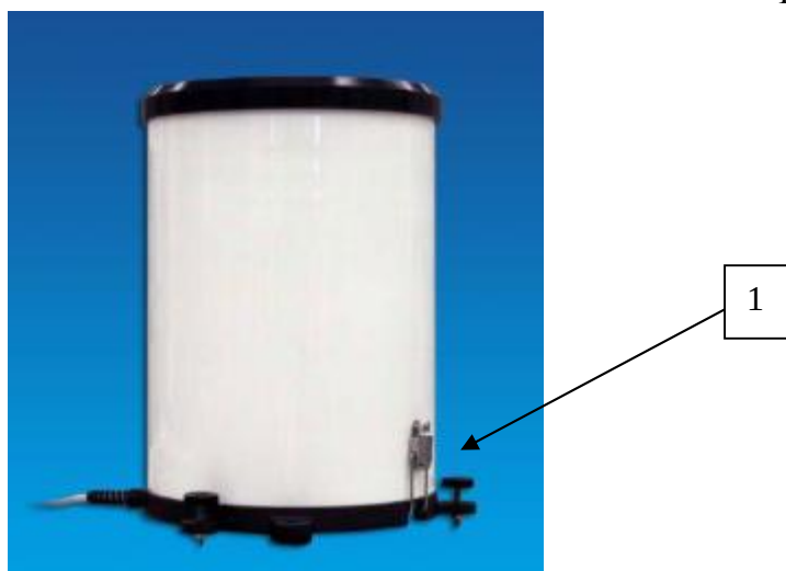
Рисунок 2 Схема пломбирования осадкомеров RG13/RG13H 1 – пломбы на корпусе устройства
