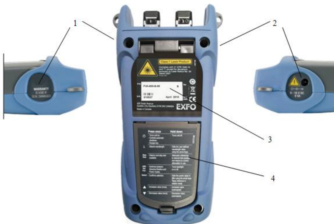
Рисунок 2 - Схема корпуса измерителей оптической мощности PPM-350 (вид сзади/сбоку) 1, 2 – места нанесения защитных наклеек; 3 – место нанесения маркировки (под откидывающейся подставкой); 4 – аккумуляторный отсек.
